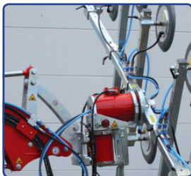
Módulo hidráulico HDS para girar y la inclinación por control remoto de radio.
