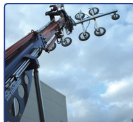
Mayor alcance a través de un doble telescopio hidráulico.
